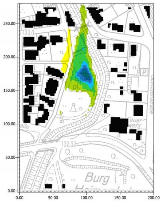
Abbildung 5-38 Differenzen Szenario minus IST: Lufttemperaturen um 15 Uhr bei einer Anströmung aus Süd
