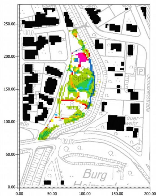
Abbildung 5-35 Differenzen Szenario minus IST: Oberflächentemperaturen um 0 Uhr
